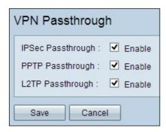
Passaggio 2. (Facoltativo) Per consentire il passaggio del tunnel IPSec attraverso il router, selezionare la casella di controllo **Abilita pass-through IPSec**. Questa opzione deve essere abilitata quando sul router è in uso un tunnel VPN IPSec o se il router si trova tra due endpoint di un tunnel VPN IPSec.
