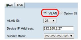
Passaggio 1. Fare clic sul pulsante di opzione **VLAN** per configurare le impostazioni DHCP per una VLAN specifica. Le VLAN (Virtual Local Area Network) sono reti suddivise logicamente in più domini di broadcast.
