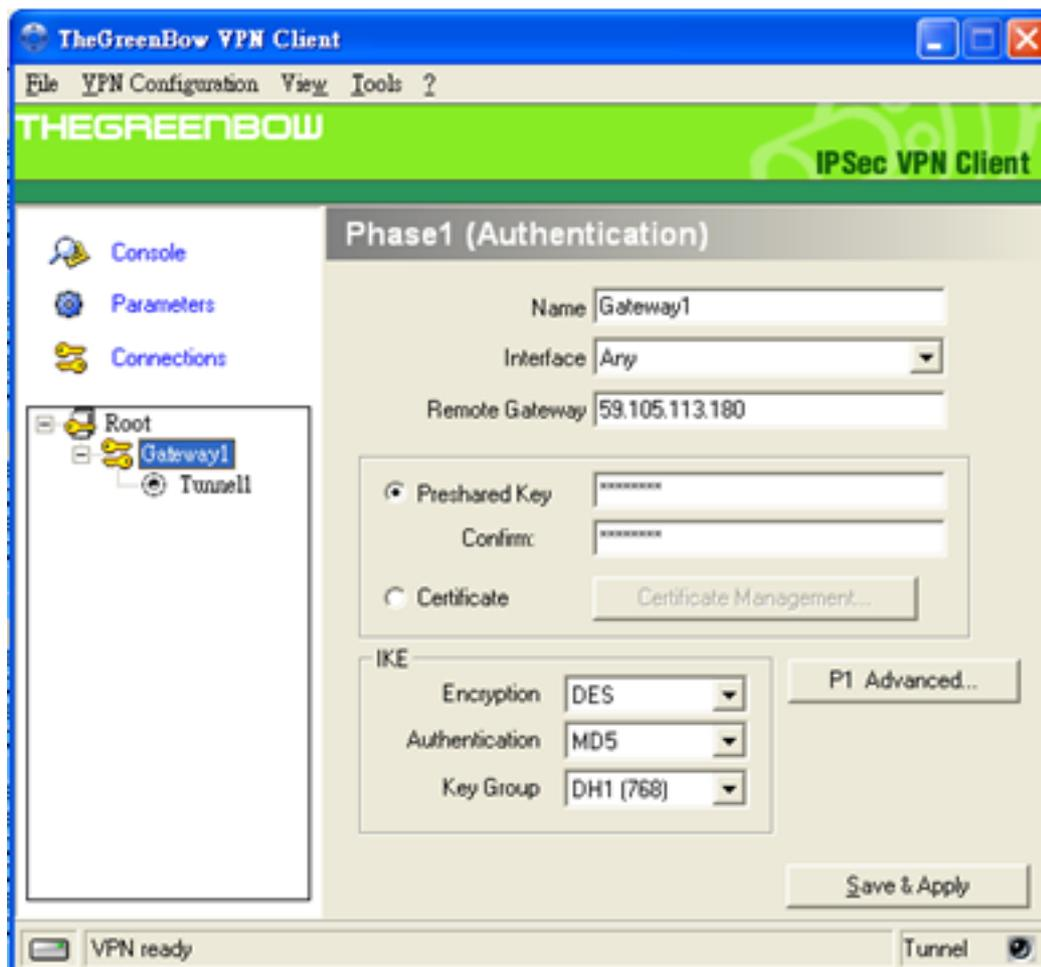
Passaggio 25. Nel campo Gateway remoto immettere l'indirizzo IP WAN del router remoto.
