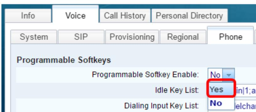
Passaggio 6. Scegliere un campo numerico programmabile per il tasto softkey su cui configurare una funzione del telefono.
