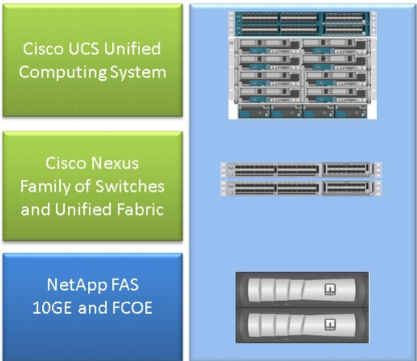
Il FlexPod più comune è costituito da uno chassis Cisco UCS serie B collegato tramite Fabric Interconnect (FI) agli switch Nexus 5500 e ai filer NetApp. Un'altra soluzione, chiamata FlexPod Express, utilizza uno chassis UCS serie C collegato agli switch Nexus 3000. In questo documento viene descritto il FlexPod più comune.
