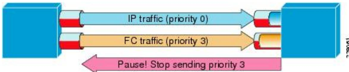
Il comando **show interface priority-flow-control** permette all'amministratore di osservare il comportamento delle classi per-QoS dei frame di pausa delle priorità.
