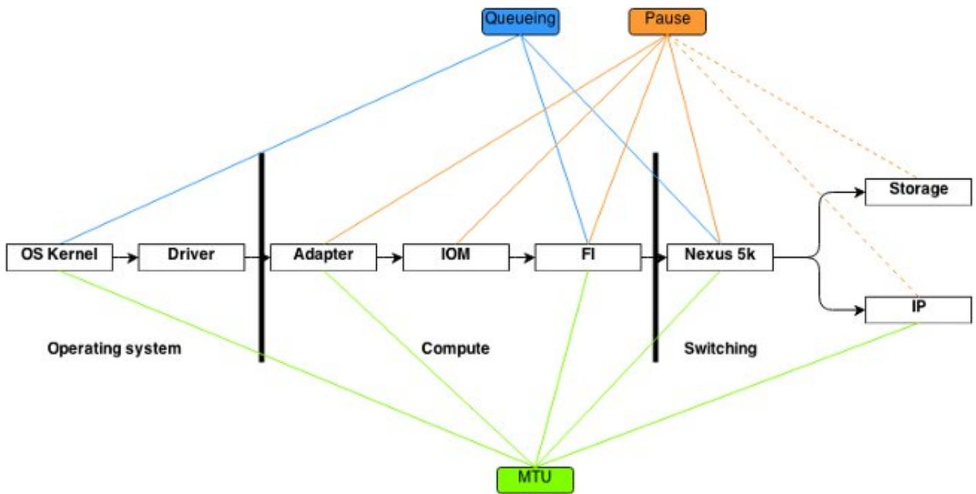
Questo diagramma è inteso come un'analisi dei componenti di un frame che passano attraverso l'ambiente FlexPod. Non riflette la complessità di nessuno dei blocchi ed è semplicemente un modo per memorizzare dove particolari funzionalità devono essere configurate e verificate.
