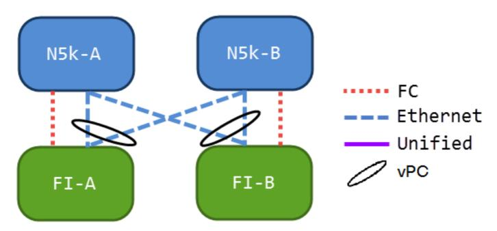
Questa configurazione non contiene collegamenti unificati, ma rappresenta il modo più semplice per integrare gli uplink FCoE nell'ambiente corrente. Questa configurazione elimina la necessità di collegare i fabric FC.
