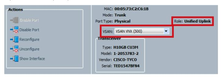
A questo punto, l'UCS è configurato per il traffico unificato. In questo esempio non vengono utilizzati canali porta. Tuttavia, a questo punto, è possibile configurare normalmente i canali delle porte. Assicurarsi di impostare la VSAN nella scheda VSAN per il canale della porta.
