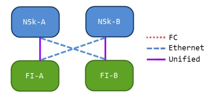
In questa configurazione, gli switch Nexus serie 5000 (N5ks) e i dispositivi di archiviazione sono interconnessi, ma non collegati tra loro tramite canale della porta. In questo modo è possibile disporre di alcuni uplink unificati, mantenendo tuttavia una progettazione di rete ben nota.
