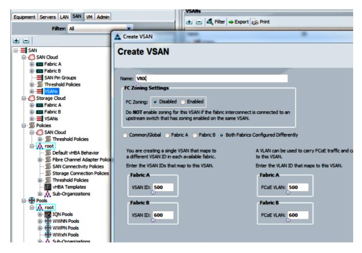
In questa configurazione, VSAN 500 è esterno al fabric A e VSAN 600 è esterno al fabric B. Si tratta della stessa configurazione che verrebbe utilizzata per creare una VSAN per una FC normale.
