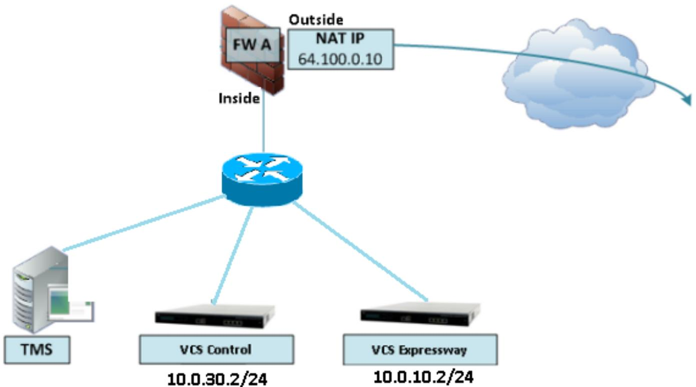
Questo tipo di implementazione richiede la conversione dell'indirizzo IP di controllo VCS nell'indirizzo IP interno dell'appliance ASA per forzare il traffico di ritorno sull'appliance ASA e evitare problemi di route asimmetrici per la reflection NAT.
