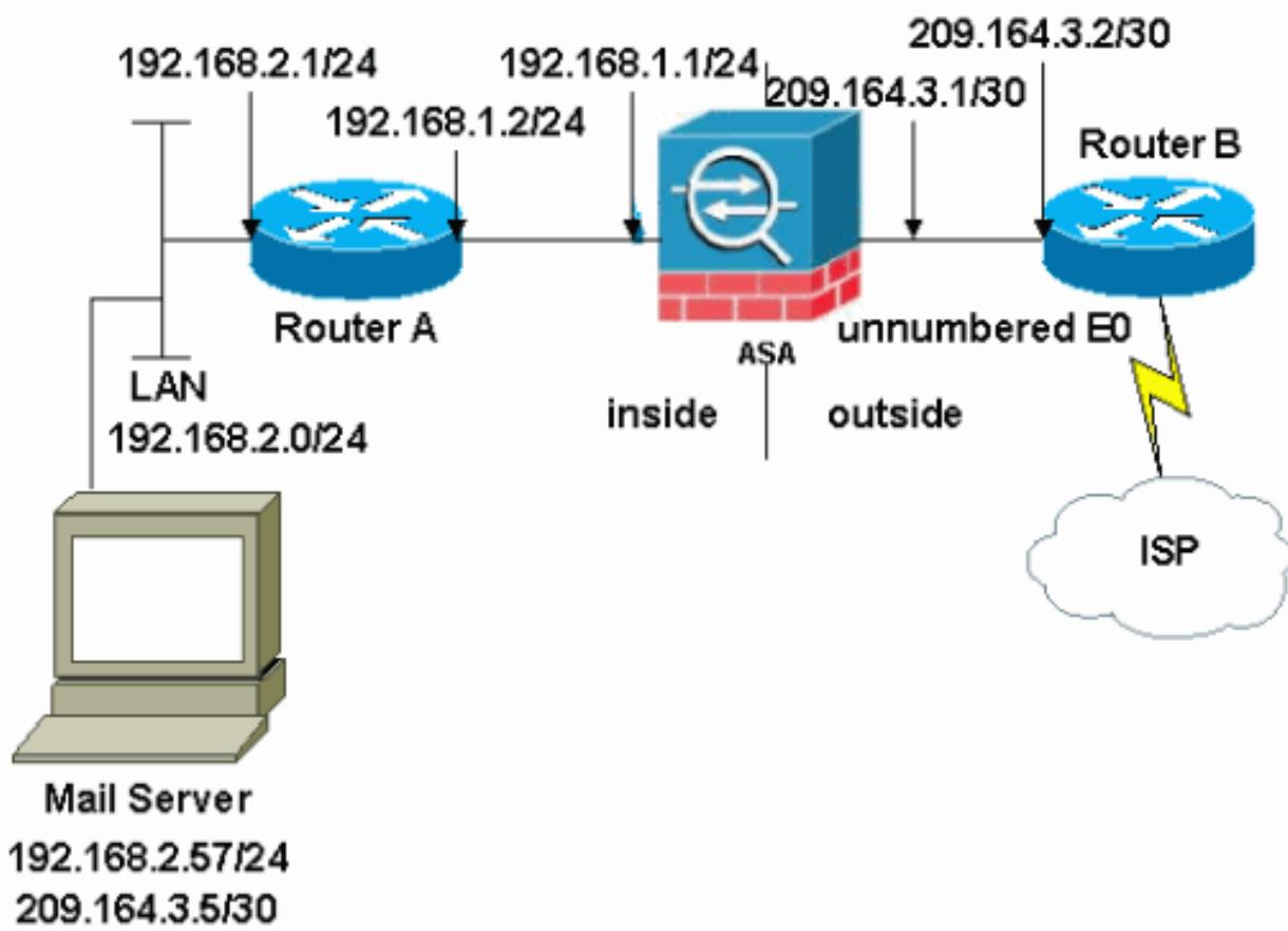
**Nota:** gli schemi di indirizzamento IP utilizzati in questa configurazione non sono legalmente instradabili su Internet. Si tratta degli indirizzi [RFC 1918](#) utilizzati in un ambiente lab.
