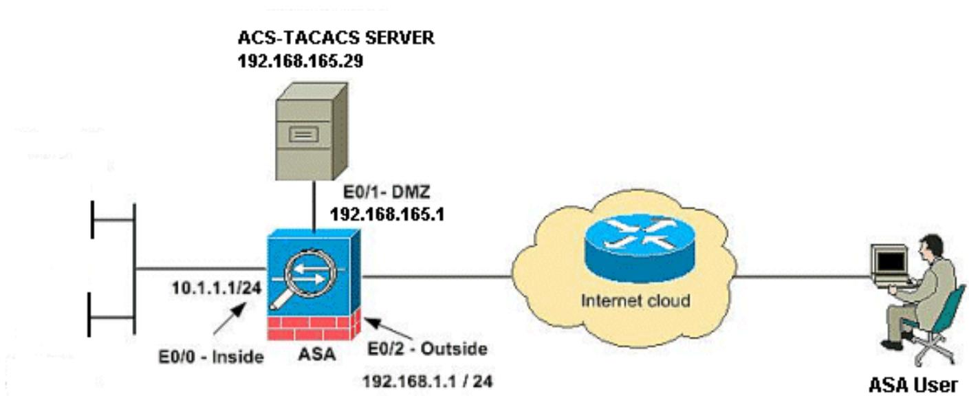
**Nota:** gli schemi di indirizzamento IP utilizzati in questa configurazione non sono legalmente instradabili su Internet. Si tratta degli indirizzi RFC 1918 utilizzati in un ambiente lab.
