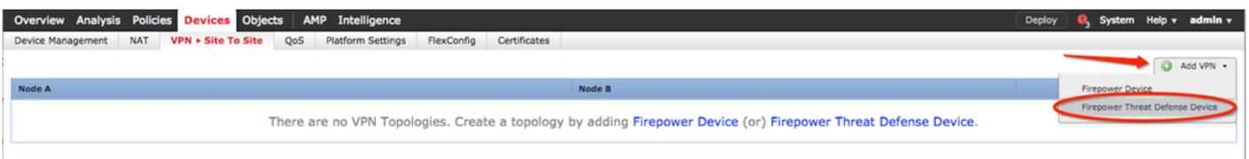
Passaggio 3. Nella **Create new VPN Topology**, specificare **Topology Name**, controllare la **IKEV1** e fare clic sul pulsante **IKE**. Ai fini di questo esempio, le chiavi già condivise vengono utilizzate come metodo di autenticazione.
