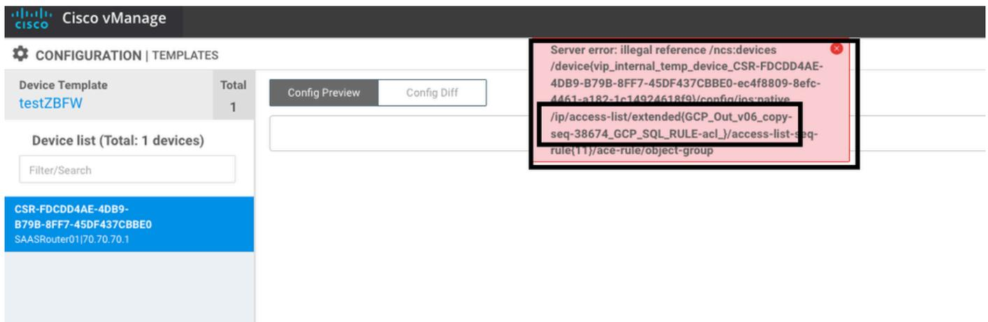
In questo esempio, il criterio di sicurezza dispone di un criterio di prevenzione delle intrusioni per VPN/VRF 1, ma i dispositivi non dispongono di alcun VRF 1 configurato. Pertanto, il gestore invia un riferimento non valido per tale sequenza di criteri.
