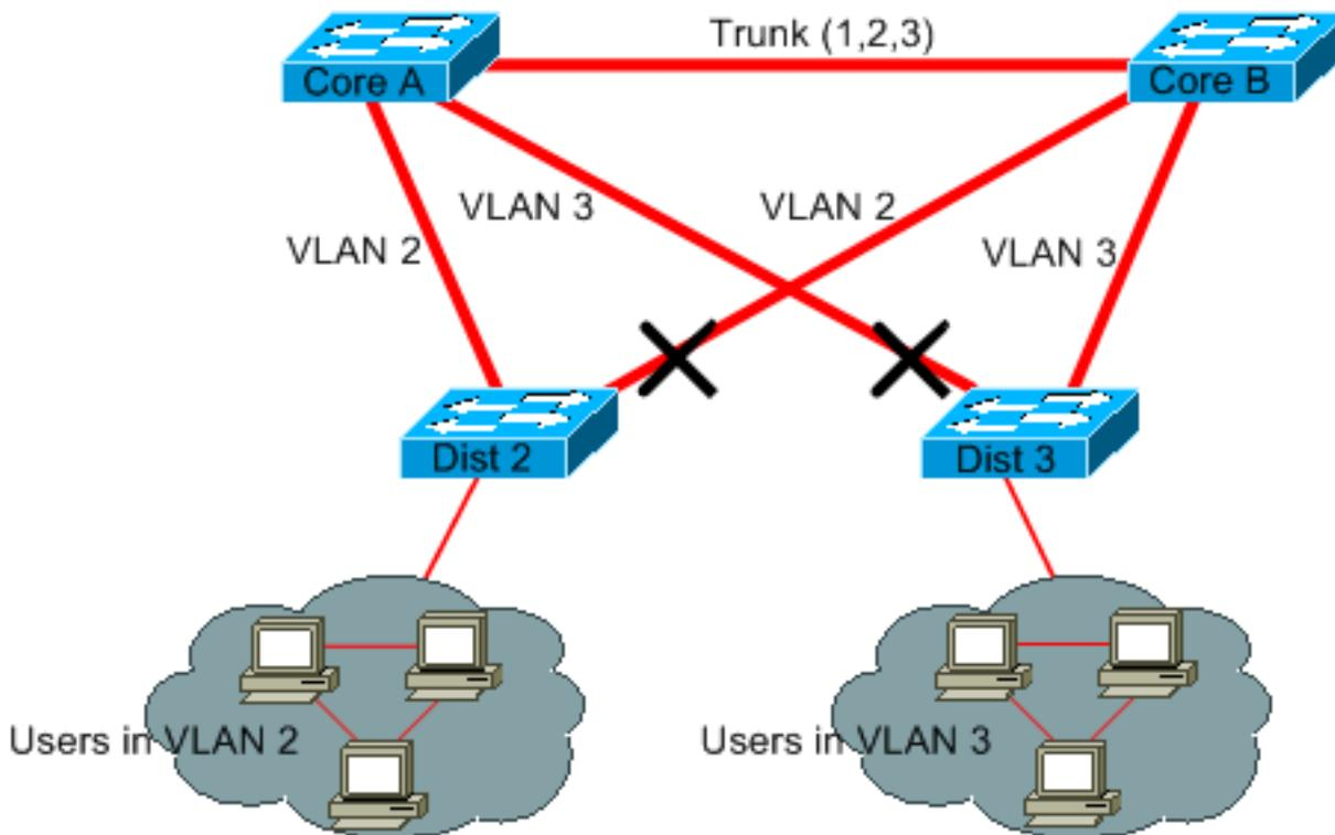
In questo design, viene bloccata una sola porta per ciascuna VLAN. Inoltre, con questo design, è possibile rimuovere tutti i collegamenti ridondanti in un solo passaggio se si arresta il Core A o il Core B.
