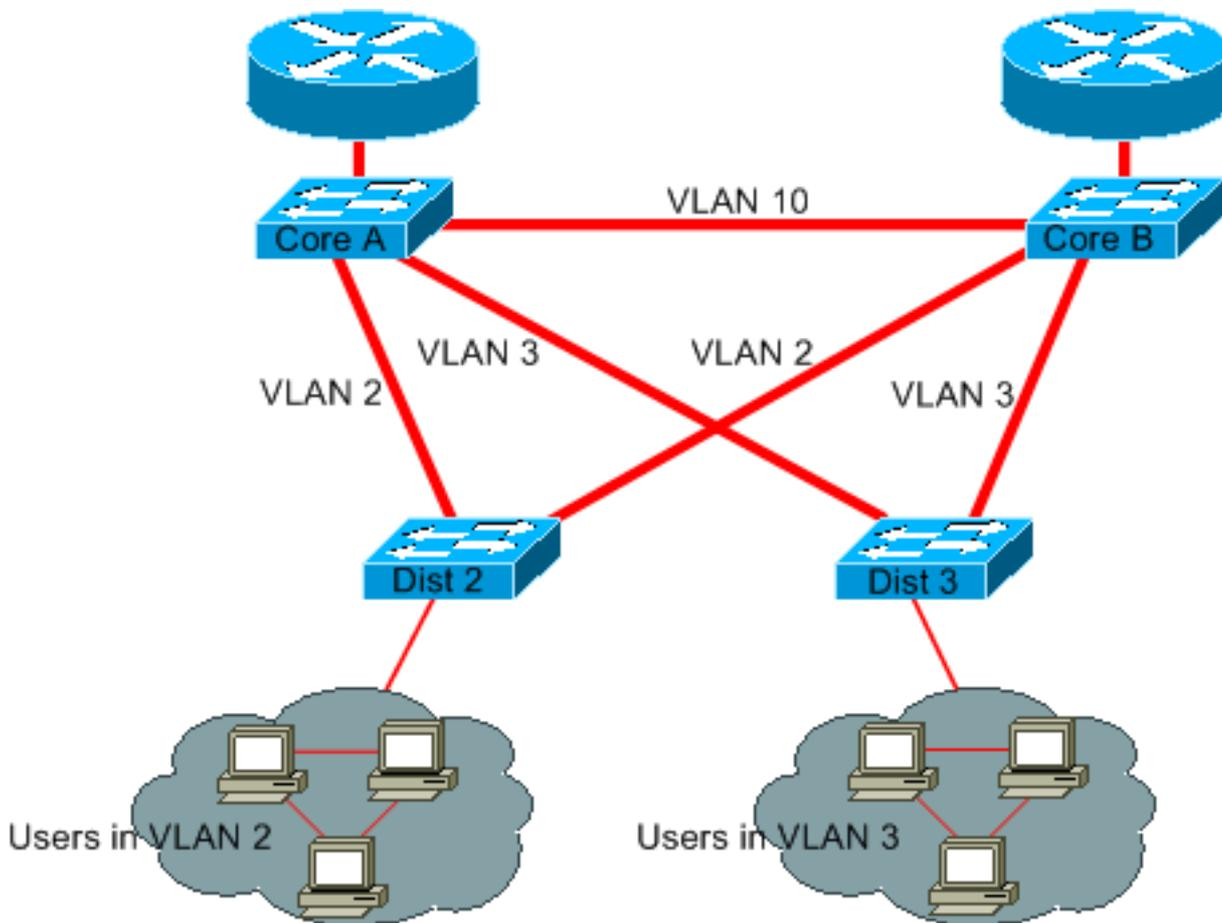
In questo caso il Core A e il Core B sono switch di livello 3. La VLAN 2 e la VLAN 3 non sono più collegate tra Core A e Core B, quindi non è possibile creare un loop STP.
