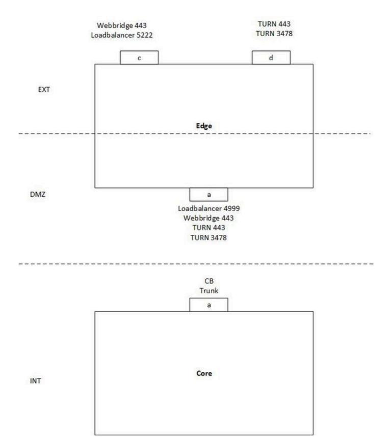
L'immagine rappresenta un esempio di configurazione di un singolo server diviso con un server Core e un server Edge con i seguenti requisiti:
