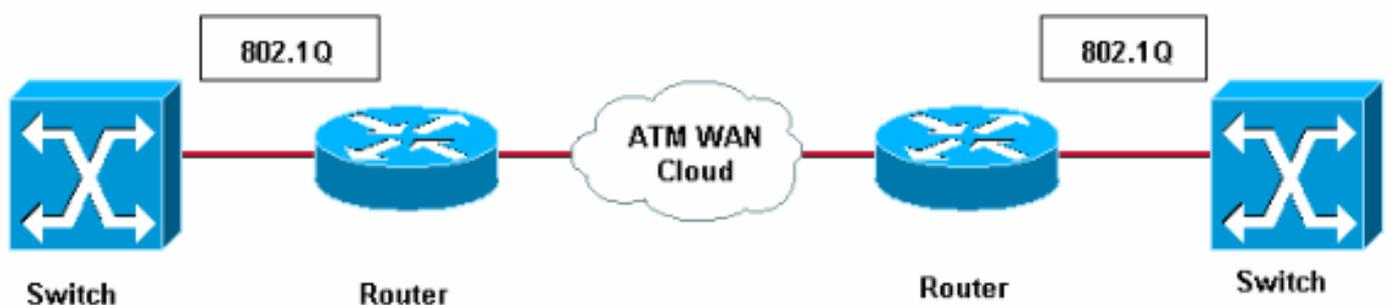
Tuttavia, esiste un modo alternativo per creare VLAN end-to-end. Configurare entrambi i router con lo stesso insieme di gruppi di bridge e sottointerfacce 802.1Q. In altre parole, le due estremità del router hanno una mappatura uno-a-uno tra un gruppo di bridge e una sottointerfaccia 802.1Q. soluzione non applicabile a Cisco 7600.
