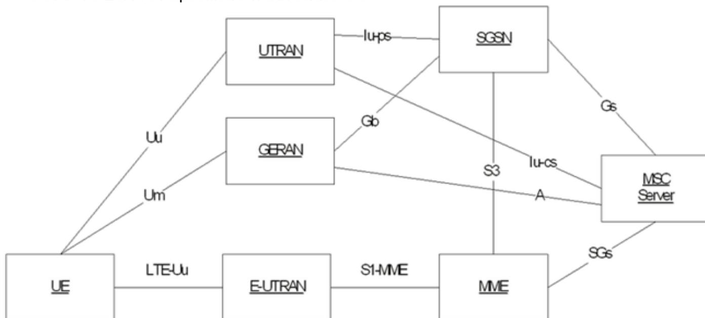
Ce diagramme est basé sur les SG qui utilisent le protocole SCTP (Stream Control Transmission Protocol) pour le transport :
