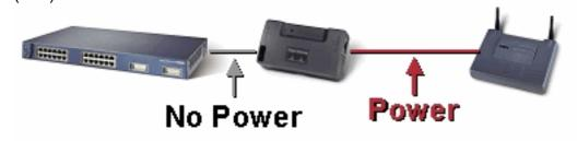
Remarque : La distance maximale prise en charge pour l'alimentation en ligne est de 100 mètres (m). Cette distance est identique pour chaque connexion Ethernet sur un câble de catégorie 5.
