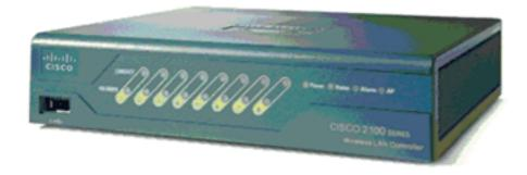
Le contrôleur 2100 est alimenté par une alimentation externe qui accepte l'alimentation d'une prise électrique (100 à 240 VCA, 50 à 60 Hz).
