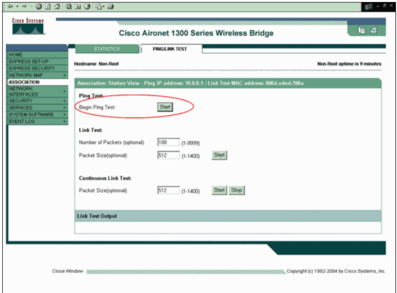
La sortie de ping confirme l'établissement de la Connectivité point par point entre les ponts sans fil.
