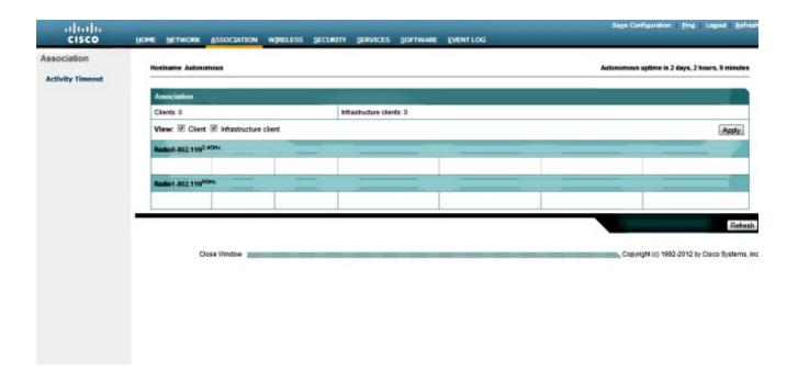
8. Un point d'accès autonome peut également être utilisé pour les services de domaine sans fil (WDS). Cliquez sur l'onglet Wireless afin de configurer ou d'afficher les paramètres WDS :
