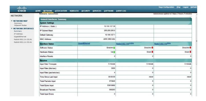
6. Pour afficher ou modifier les paramètres du port GigabitEthernet, Radio 2,4 GHz et Radio 5 GHz, accédez à la section Network Interface.
