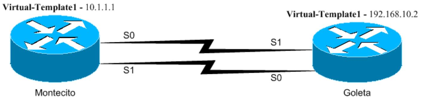
Les routeurs Montecito et Goleta sont connectés dos à dos via les interfaces Serial0 et Serial1. Cette configuration utilise un modèle virtuel de chaque côté, le protocole PPP (Multilink Point-to-Point Protocol), ainsi que des ponts et routes IP et IPX entre les routeurs.
