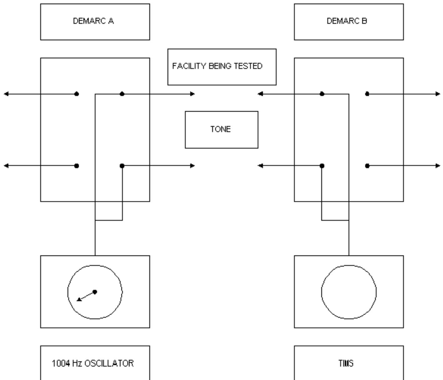
L'équipement est configuré pour tester le circuit entre le point de démarcation à A et le point de
