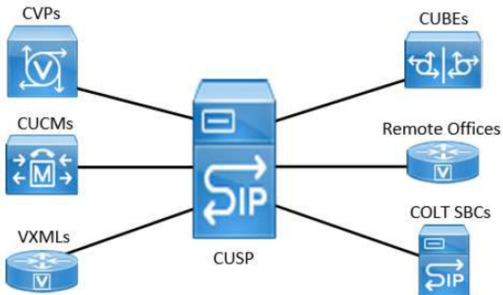
L'UCCE étant déployé avec CVP et TRANCHANT avec le soi-disant modèle complet, il n'y a aucun joncteur réseau de SIP entre CUCM et les CUBES. Toute la transmission entre le CUBE et le CUCM va par l'intermédiaire d'un joncteur réseau simple de SIP au TRANCHANT.
