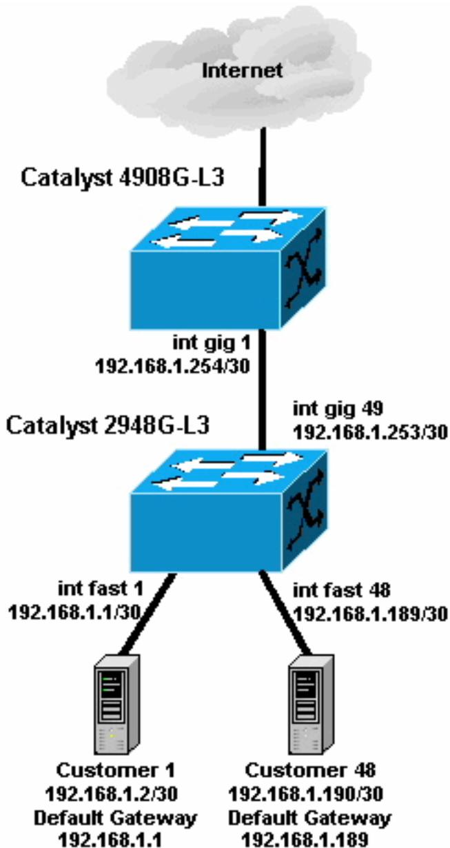
Dans cette topologie, le fournisseur de services a découpé en sous-réseaux 192.168.1.0/24 à l'aide de masques de sous-réseau 30 bits. Pour chaque sous-réseau, une adresse d'hôte est attribuée à l'une des interfaces Fast Ethernet du 2948G-L3 et l'autre IP au serveur du client. Le serveur du client 1 se trouve dans le sous-réseau 192.168.1.0/30. L'adresse IP 192.168.1.1/30 est attribuée à Fast Ethernet 1 et l'adresse IP 192.168.1.2/30 est attribuée au serveur du client 1.
