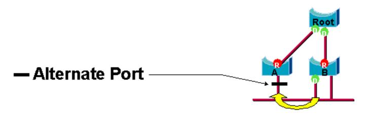
Un port de secours est un port qui est bloqué en recevant des BPDU plus utiles en provenance du même pont que celui sur lequel le port se trouve. Ce diagramme illustre :
