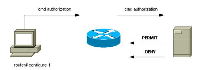
Quand un utilisateur s'authentifie à un périphérique réseau avec TACACS+ dans une tentative de procédure de connexion ASCII simple, ce processus se produit généralement :
