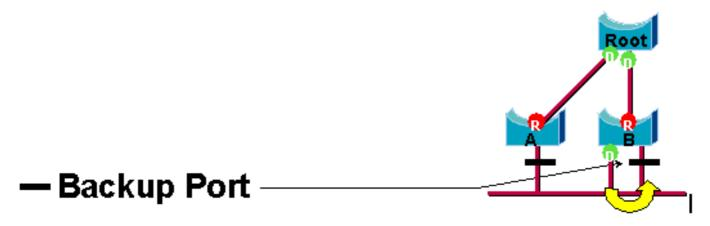
Cette distinction a déjà été faite en interne dans la norme 802.1D. C'est essentiellement comme cela que fonctionne Cisco UplinkFast. Le raisonnement derrière ceci est qu'un port alternatif fournit un autre chemin au pont racine. Par conséquent, ce port peut remplacer le port racine si celui-ci échoue. Naturellement, un port de secours fournit une connectivité redondante au même
