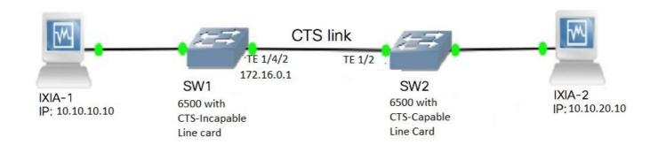
Étape 1. Configuration de CTS Layer3 sur l'interface de sortie entre SW1 et SW2
