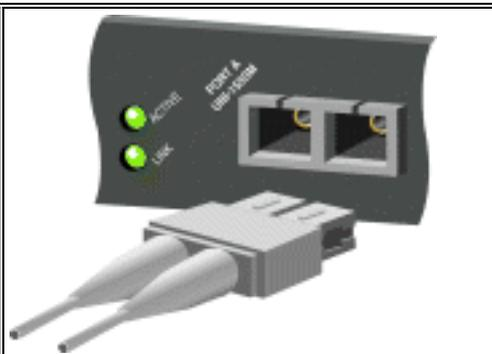
Utilisé afin de se connecter aux ports fibre optique 100Base-FX. Utilisez les câbles fibre multimode (MMF) avec des connecteurs MT-RJ.
