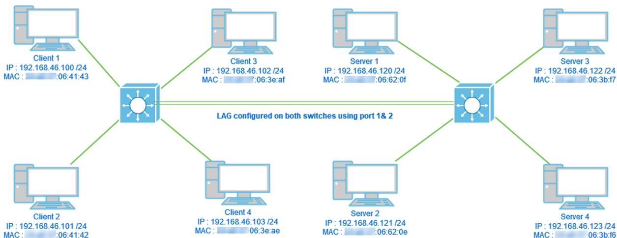
Deux commutateurs connectés via LAG à l'aide de 2 ports uniquement et de l'algorithme d'équilibrage de charge Adresse MAC/adresse IP. En outre, 4 clients connectés à un
