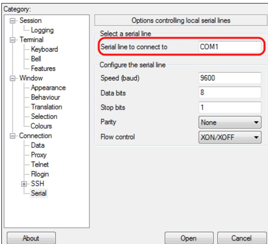
Étape 6. Dans le champ *Vitesse (en bauds)*, saisissez la vitesse de transmission numérique compatible avec le commutateur. Pour les commutateurs gérés des gammes 250 et 350, la vitesse doit être définie sur 115200.
