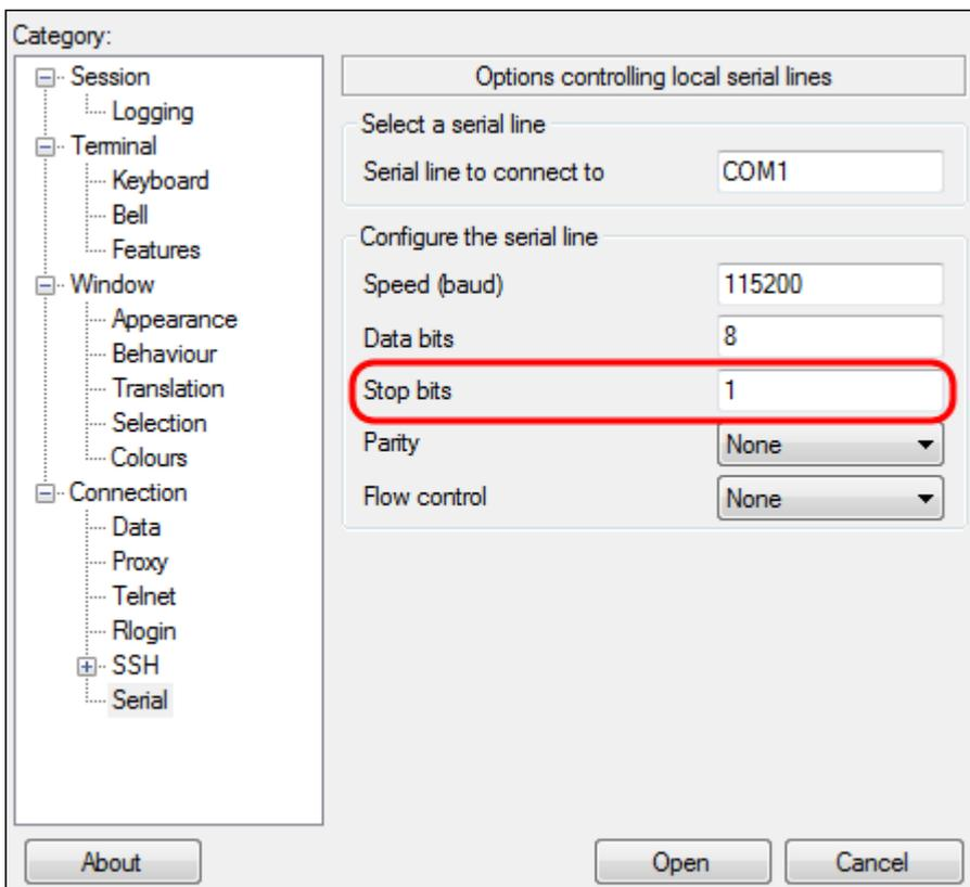
Étape 9. Dans le menu déroulant *Parité*, sélectionnez la méthode de détection des erreurs de transmission. La méthode recommandée pour détecter les erreurs de transmission est **None**.
