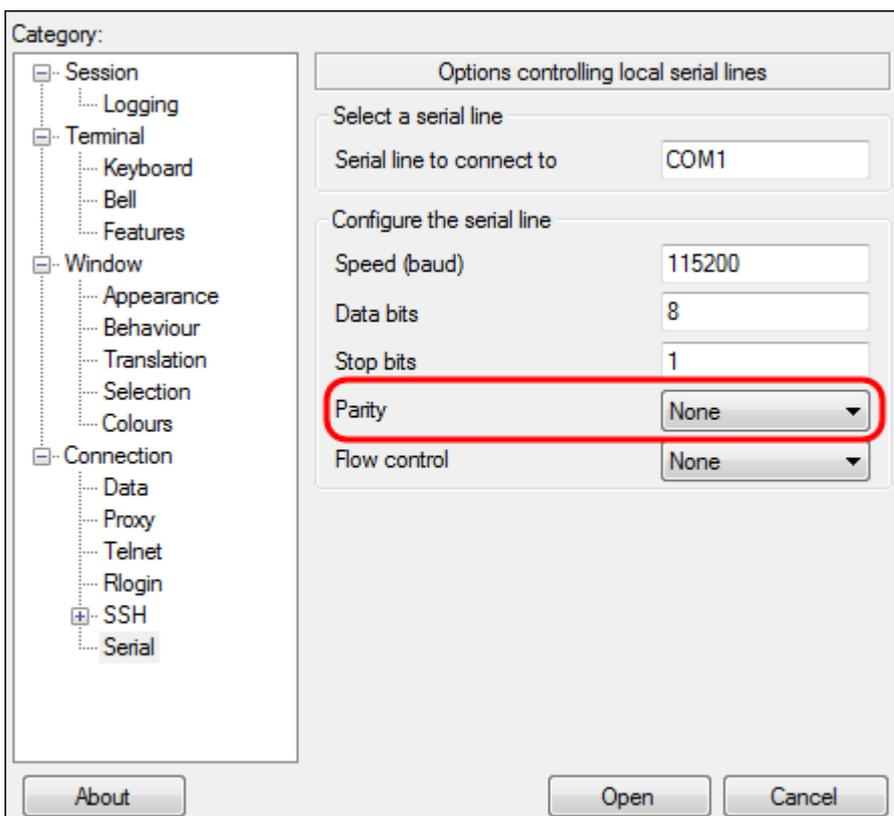
Étape 10. Dans le menu déroulant *Contrôle de flux*, sélectionnez la méthode permettant d'empêcher le débordement de données. La méthode recommandée pour empêcher le débordement de données est **Aucun**.
