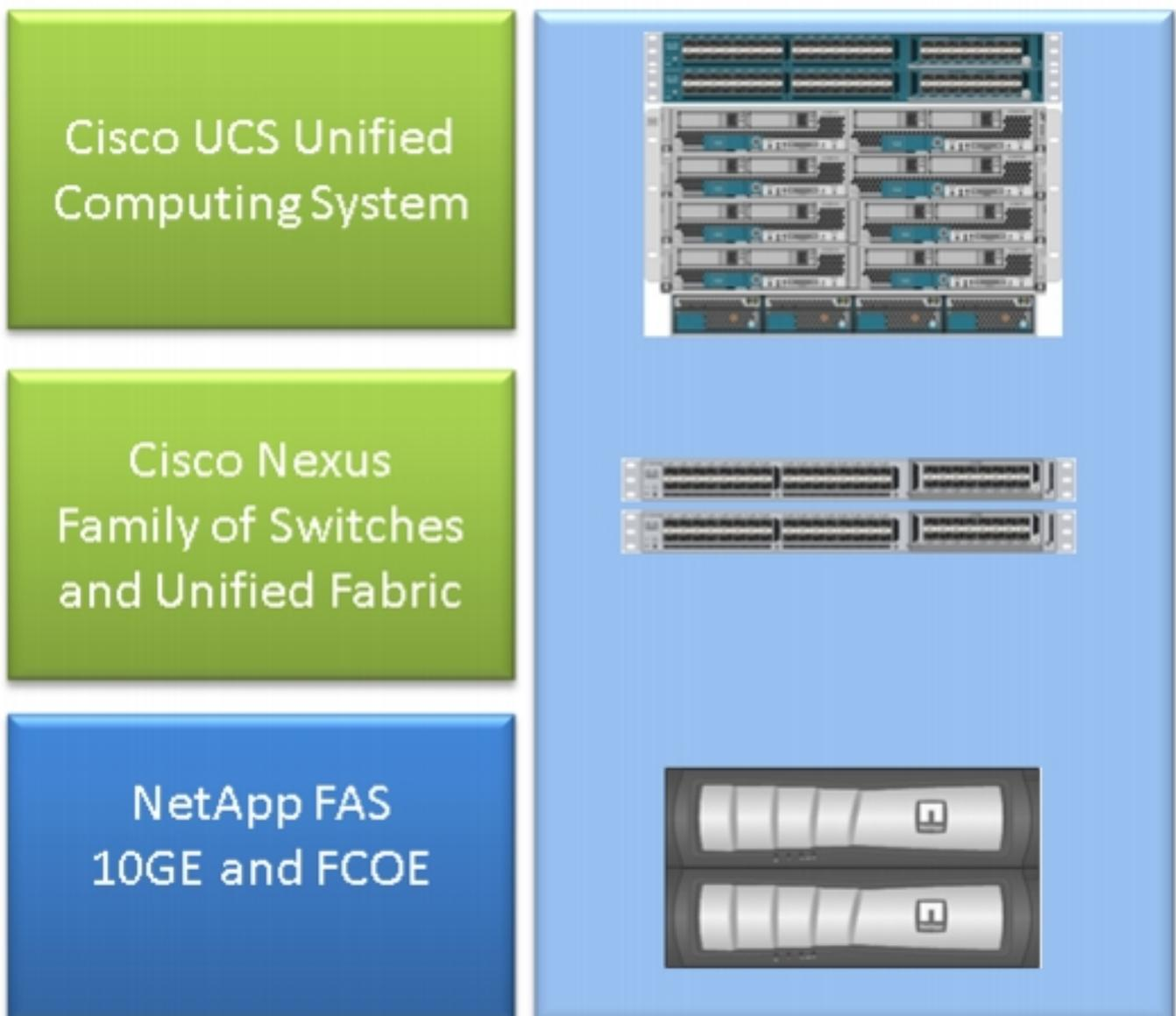
Le FlexPod le plus commun se compose de la B-gamme d'un Cisco UCS que le châssis connecté par l'intermédiaire de la matrice interconnectée (FIs) aux Commutateurs du Nexus 5500 aux fichiers de NetApp. Une autre solution, appelée le FlexPod exprès, utilise un châssis de série C UCS connecté aux Commutateurs du Nexus 3000. Ce document discute le FlexPod le plus commun.
