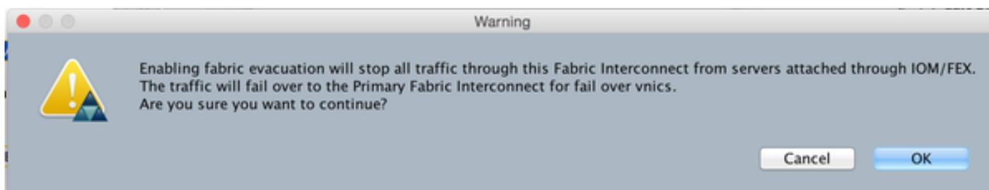
4. Cliquez sur OK pour confirmer l'évacuation du trafic de la matrice. Vous observerez que les vNICs configurés avec le Basculement de matrice le trafic de repin à la matrice alternative. Confirmez dans le système d'exploitation d'hôte que le trafic circule sur la matrice alternative.
