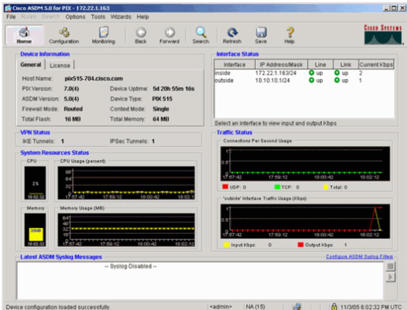
2. Sélectionnez Monitoring > VPN > VPN Connection Graphs > IPSec Tunnels afin de vérifier les détails de l'établissement du tunnel.
