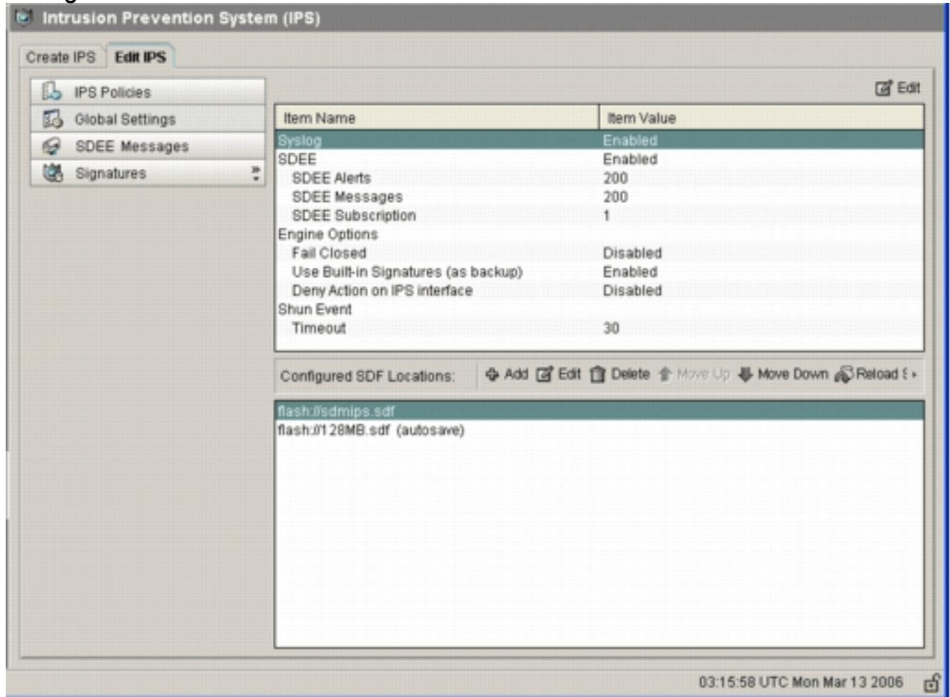
La partie supérieure de l'interface utilisateur affiche les paramètres globaux. La moitié inférieure de l'interface utilisateur affiche les emplacements SDF actuellement configurés. Dans ce cas, le fichier 256MB.sdf de la mémoire flash est configuré.
