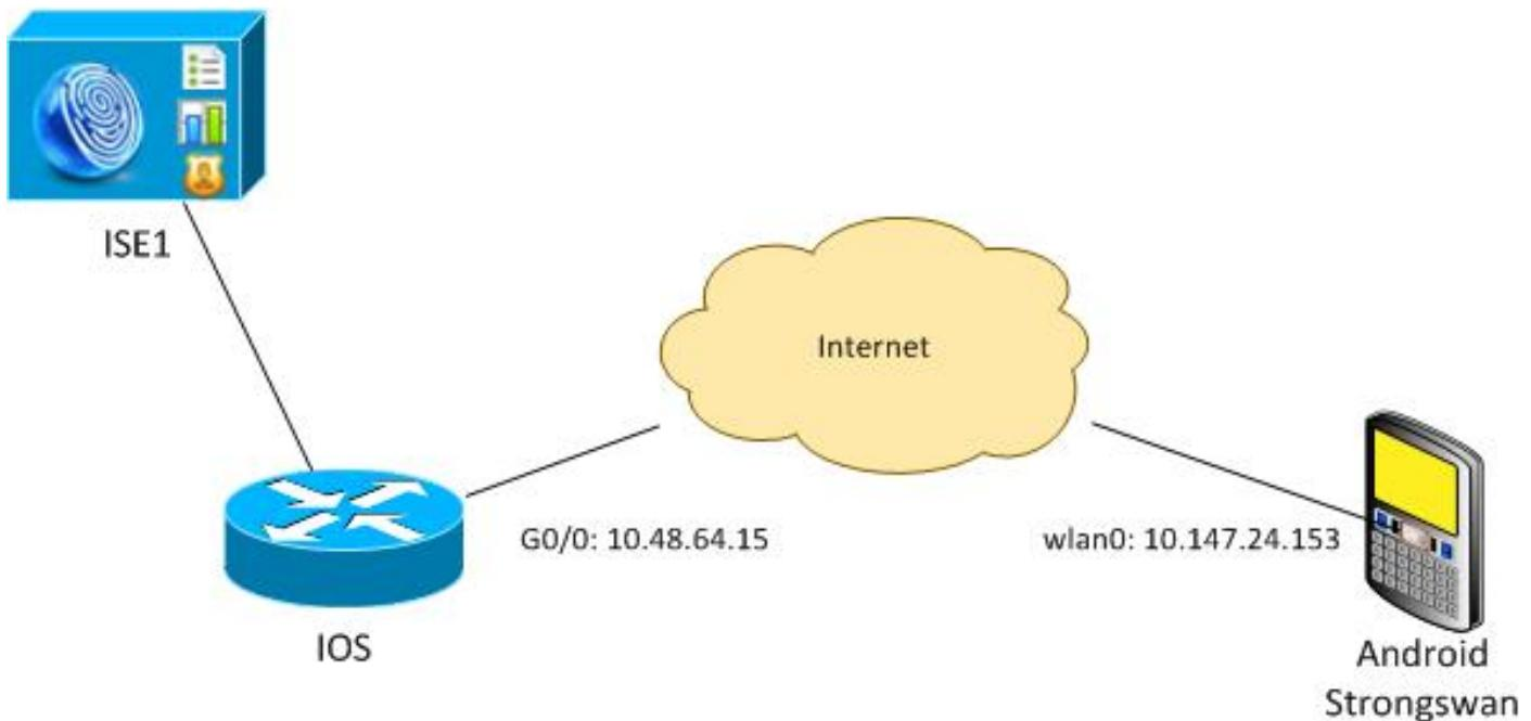
Android strongSwan établit un tunnel IKEv2 avec une passerelle logicielle Cisco IOS afin d'accéder aux réseaux internes en toute sécurité.
