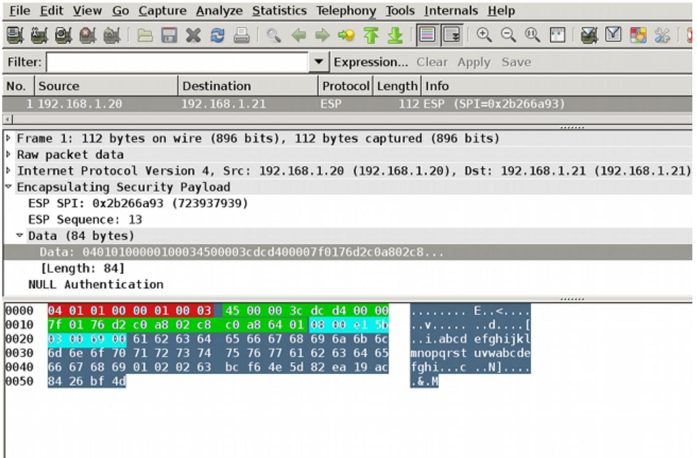
Wireshark a été utilisé pour décoder le cryptage Null pour l'index des paramètres de sécurité (SPI). Dans l'en-tête IPv4, les adresses IP source et de destination sont les adresses IP Internet des routeurs (utilisées comme source et destination du tunnel).
