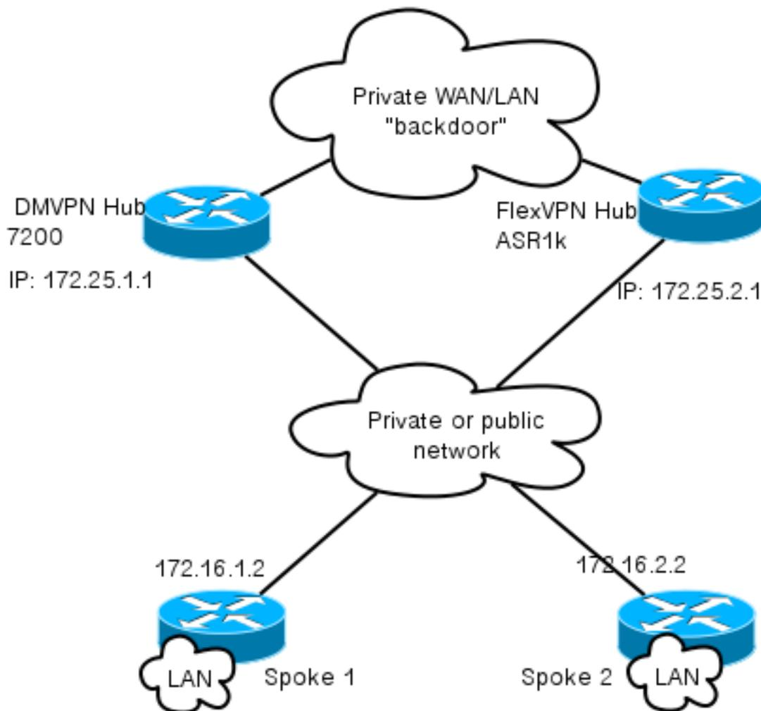
Notez la liaison entre les deux concentrateurs. Cette liaison est essentielle pour permettre la connectivité entre les clouds FlexVPN et DMVPN pendant la migration. Il permet aux rayons déjà migrés vers FlexVPN de communiquer avec les réseaux DMVPN et vice versa.
