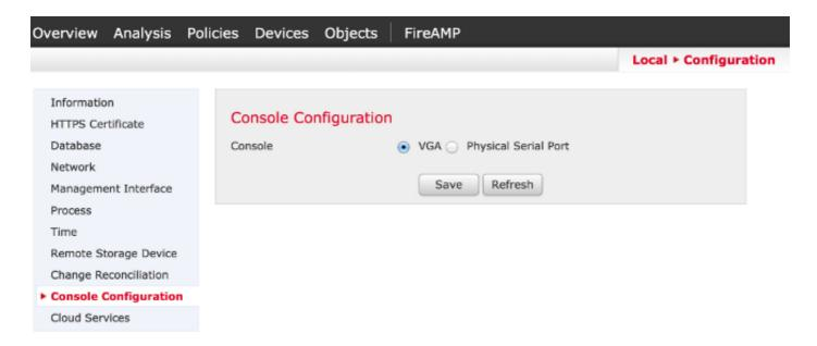
Ensuite, activez LOM dans l'interface graphique utilisateur (GUI), puis redémarrez l'appareil. Dans l'interface graphique utilisateur (GUI) de l'appareil, choisissez **Local > Configuration > Console**Configuration (local > configuration > configuration de la console). Choisissez **Physical Serial Port**(port série physique) ou LOM, cliquez surSave (enregistrer), puis cliquez sur OK pour redémarrer.
