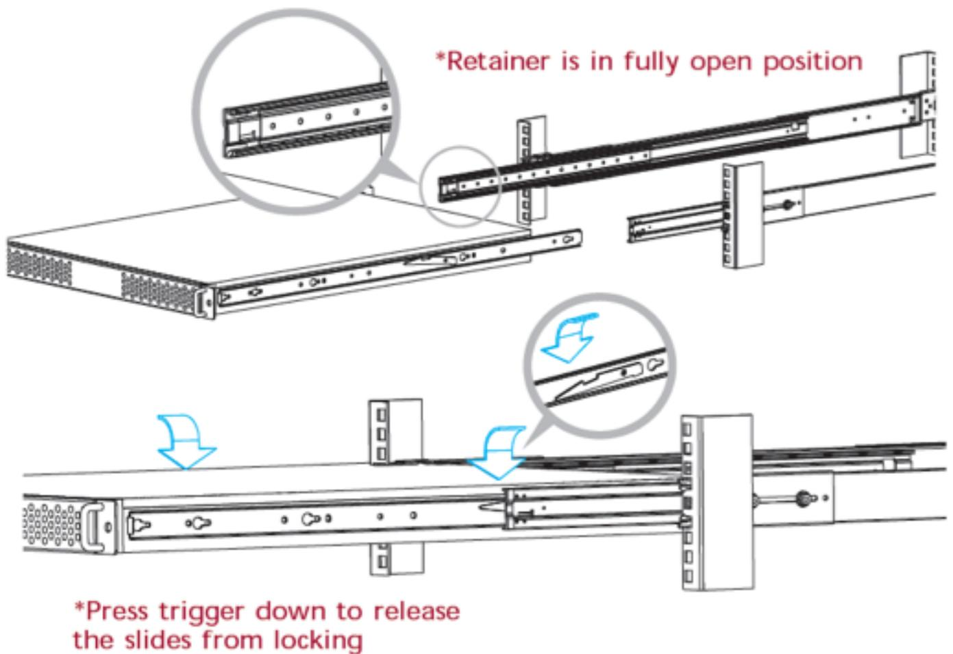
Les instructions d'installation du kit de rail fournies avec le package d'origine expliquent comment appuyer sur le déclencheur pour libérer les diapositives de la position verrouillée.
