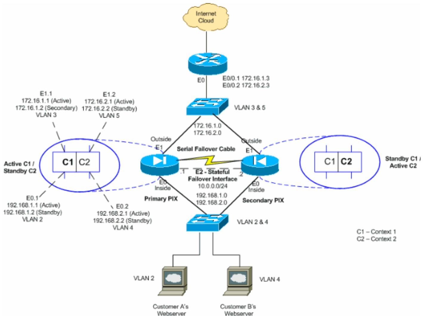
Suivez ces étapes afin de configurer le basculement actif/actif à l'aide d'un câble série en tant que lien de basculement. Les commandes utilisées dans cette tâche sont entrées sur l'unité principale de la paire de basculement. L'unité principale est l'unité qui a l'extrémité de câble marquée « Primary » branchée sur elle. Pour les périphériques en mode de contexte multiple, les commandes sont entrées dans l'espace d'exécution du système, sauf indication contraire.
