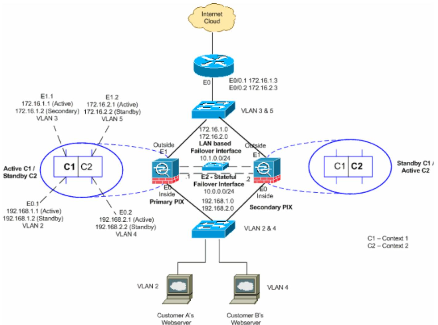
Cette section décrit comment configurer le basculement actif/actif avec un lien de basculement Ethernet. Quand vous configurez le basculement basé sur le LAN, vous devez démarrer le périphérique secondaire pour identifier le lien de basculement afin que le périphérique secondaire puisse obtenir la configuration en cours du périphérique principal.
