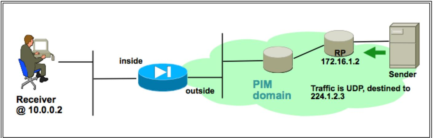
Dans ce cas, les données peuvent être reçues au niveau de l'interface externe de l'ASA, et transmises au récepteur de multidiffusion sur l'interface interne. Étant donné que le récepteur se trouve dans le même sous-réseau IP que l'interface interne de l'ASA, attendez-vous à voir un rapport IGMP reçu à l'interface interne lorsque le client demande à recevoir le flux. L'adresse IP de l'expéditeur est 192.168.1.50.
