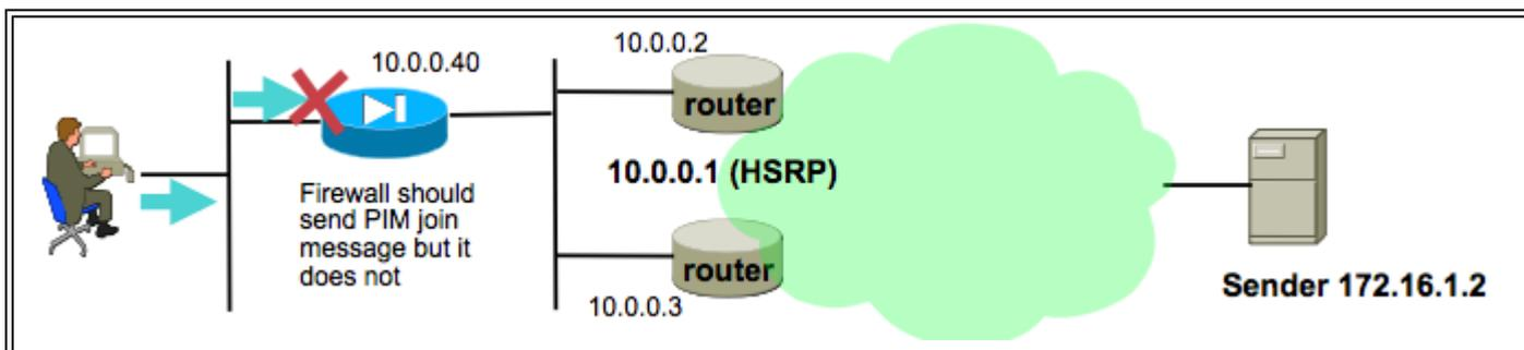
Le résultat de la commande debug pim montre que l'ASA ne peut pas envoyer le message PIM au routeur de tronçon suivant en amont :
