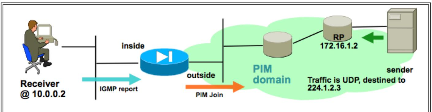
Cette sortie provient du groupe debug pim 224.1.2.3 et montre que l'ASA envoie avec succès le message de jointure PIM. L'expéditeur du flux de multidiffusion est 192.168.1.50.
