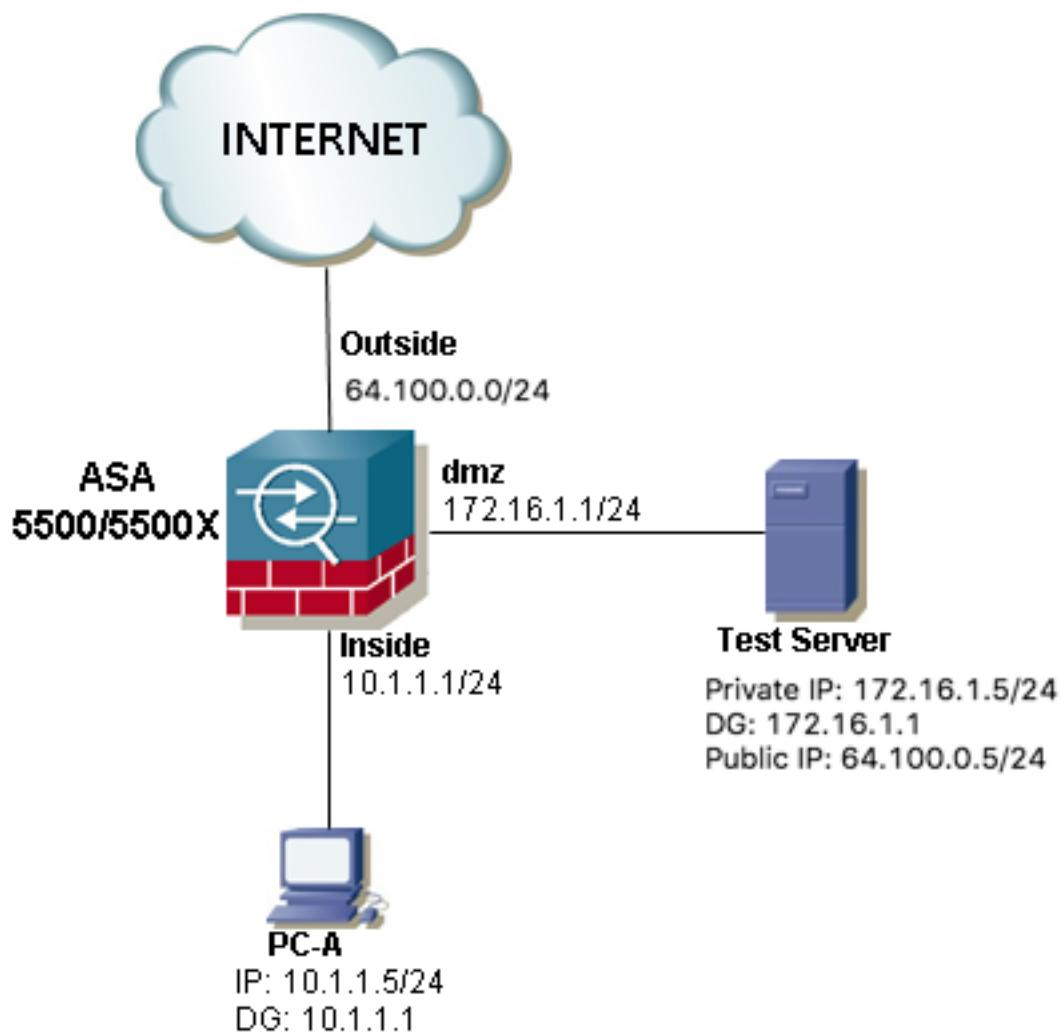
**Exemple 2 . Les hôtes source et de destination PC-A et Test Server sont connectés à la même interface ASA interne.**
