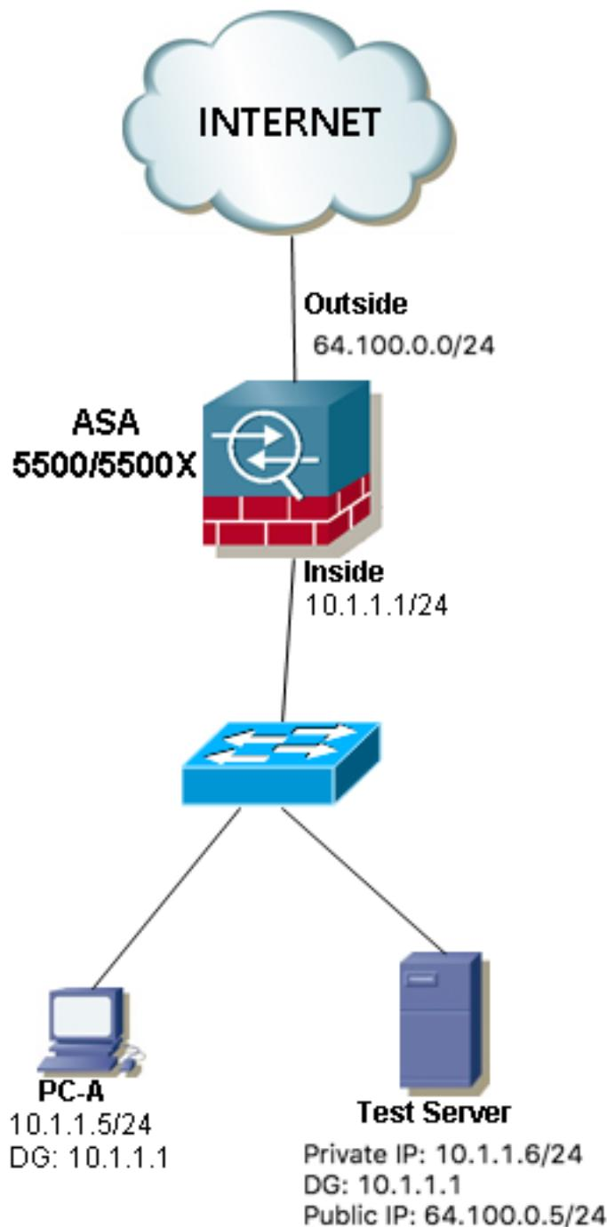
Exemple 3 . Les hôtes source et de destination PC-A et Test Server sont connectés à l'interface ASA interne, mais derrière un autre périphérique de couche 3 (il peut s'agir d'un routeur ou d'un commutateur multicouche).
