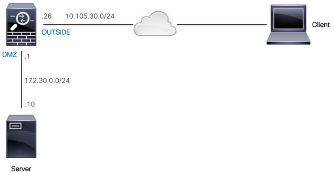
L'adresse IP réelle du serveur Web est 172.30.0.10. Une règle NAT statique un-à-un est configurée pour permettre aux utilisateurs Internet d'accéder au serveur Web avec une adresse IP traduite 10.105.130.27. L'ASA exécute le proxy-arp pour 10.105.130.27 sur l'interface externe par défaut lorsqu'une règle NAT statique est configurée avec une adresse IP traduite qui tombe dans le même sous-réseau que l'adresse IP d'interface « externe » 10.105.130.26 :
