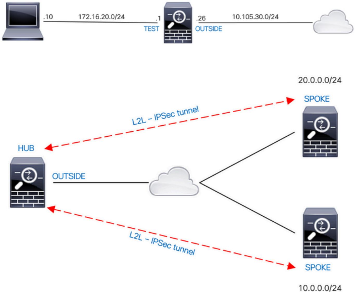
Par défaut, le trafic qui passe entre les interfaces du même niveau de sécurité est bloqué. Pour permettre la communication entre des interfaces avec des niveaux de sécurité égaux, ou pour permettre au trafic d'entrer et de sortir de la même interface (hairpin/u-turn), utilisez la commande `same-security-traffic` en mode de configuration globale.
