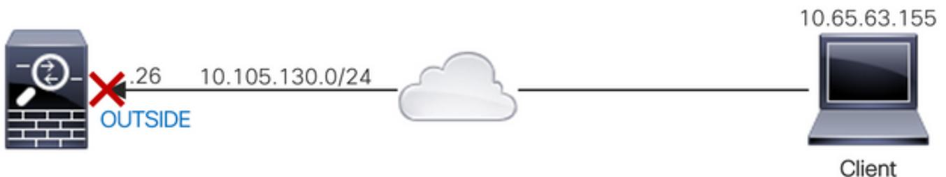
Une liste de contrôle d'accès est configurée avec le mot clé `control-plane` pour bloquer le trafic prêt à l'emploi provenant de l'adresse IP 10.65.63.155 et destiné à l'adresse IP de l'interface externe de l'ASA.
