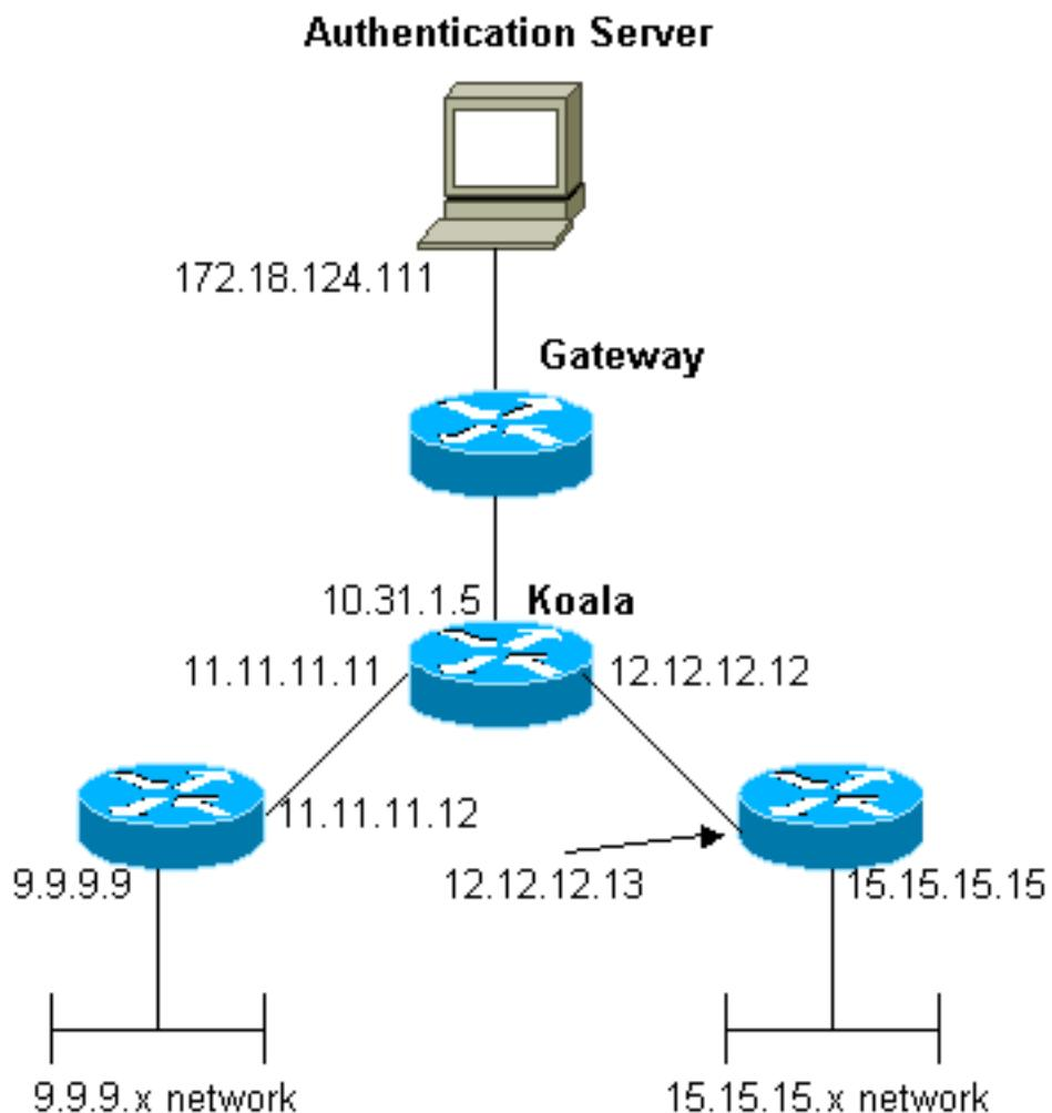
**Remarque :** les configurations permettent à l'utilisateur qui reçoit une adresse 1.1.1.x de "mypool" à ping (trafic ICMP) sur le réseau 9.9.9.x et Telnet (trafic TCP) vers le réseau 15.15.15.x. Il ne permet pas à l'utilisateur d'envoyer une requête ping au réseau 15.15.15.x ou Telnet vers le réseau 9.9.9.x.
