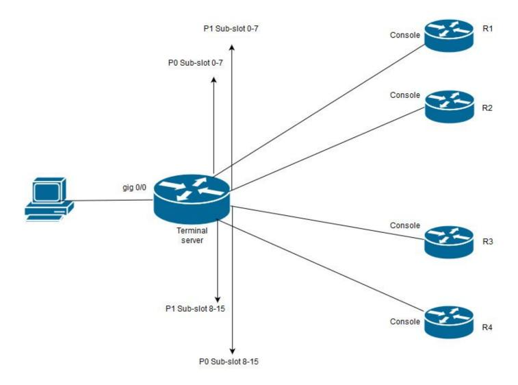
Dans ce schéma, la carte HWIC-16A du Cisco 2911 est connectée au logement 0 et deux câbles octaux sont connectés à quatre consoles de périphériques au total (2 chacune). À partir du câble octal 1(0-7), le port 0 va à R1 et le port 1 à R2. De même, à partir du câble octal 2, le port 0 va à R3 et le port 1 à R4. Un PC de test se connecte au serveur de terminal pour accéder à la console.
