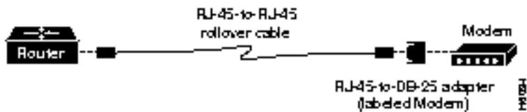
Cet adaptateur comporte un connecteur RJ-45 à une extrémité et un connecteur DB-25 mâle à l'autre extrémité.
