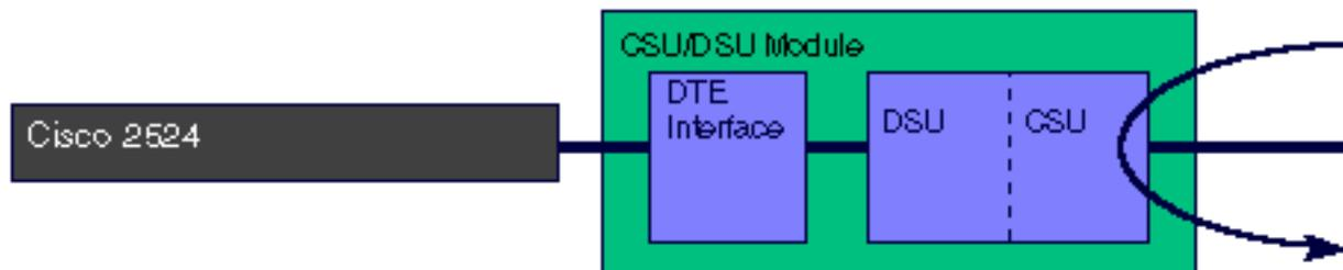
Lorsque le module CSU/DSU T1 est placé dans la **charge utile de bouclage de ligne**, l'unité CSU/DSU effectue un bouclage via la partie DSU du module. Les données ne sont bouclées que sur les [intervalles de temps configurés](#). La commande **line loopback payload** recadre la liaison de données, régénère le signal et corrige les erreurs CRC BPV (Bi-Polar Violations) et ESF (Extended Super Frame).
