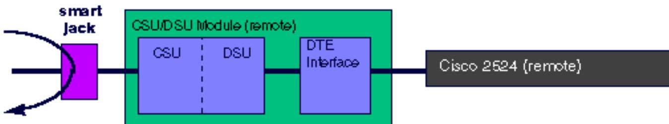
**Remarque :** si l'unité CSU/DSU T1 est configurée pour fournir l'horloge ([source d'horloge interne du module de service t1](#)), elle ne générera plus d'horloge lorsqu'elle sera placée en bouclage.
