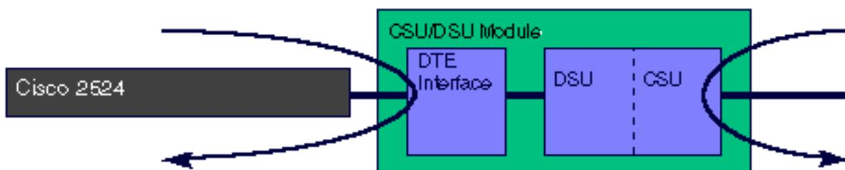
Lorsque le module CSU/DSU 56 k est placé dans la **charge utile de la ligne de bouclage**, le module CSU/DSU fait boucler la ligne par la partie DSU du module. La terminologie Adtran pour ce bouclage est « boucle only ». Si l'unité CSU/DSU est configurée pour le [mode commuté](#), une connexion doit être établie pour effectuer un bouclage de ligne.
