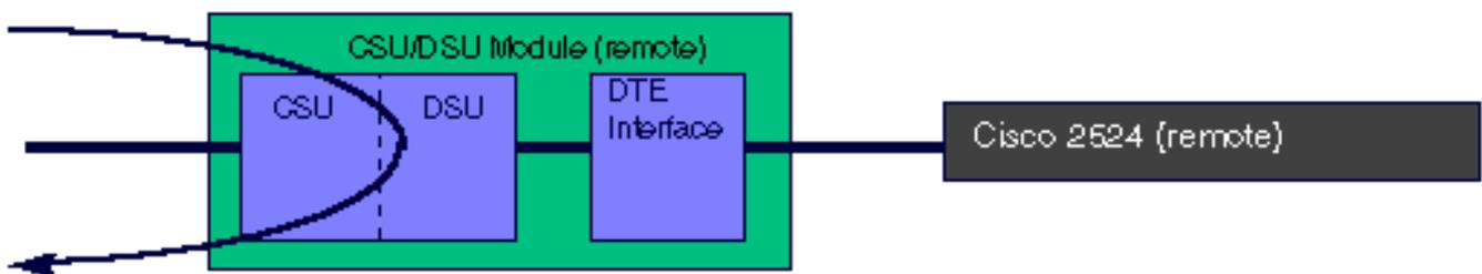
La commande **loopback remote smart-jack** envoie un code de boucle à la prise intelligente distante. Vous ne pouvez pas mettre la prise intelligente locale en mode bouclé. Le bouclage de la prise intelligente ne s'applique pas au WIC-1DSU-T1.
