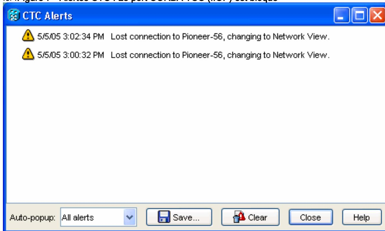
Comme solution de contournement, vous pouvez ouvrir le port d'écoute IIOB CTC. L'ID de bogue Cisco [CSCeh96275](#) (clients [enregistrés](#) uniquement) répond à ce problème. À l'avenir, la création d'un conduit pour les ports TCP 80 et 1080 sur le pare-feu suffit à fournir la prise en charge pour masquer l'adresse IP réelle de ONS 15454.
