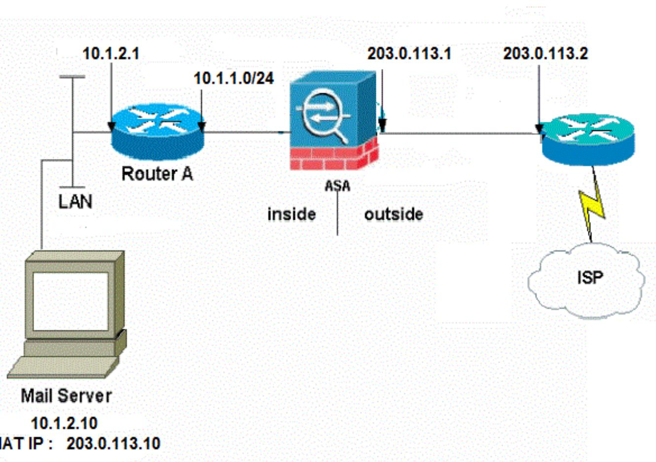
La configuration de réseau utilisée dans cet exemple à l'ASA avec un réseau interne à 10.1.1.0/24 et un réseau externe à 203.0.113.0/24. Le serveur de messagerie avec l'adresse IP 10.1.2.10 se trouve dans le réseau interne.
