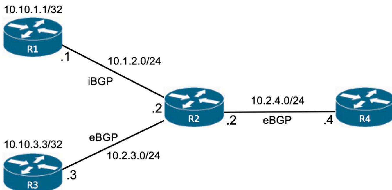
Sur le routeur R2, les routes sont affichées dans la table BGP dans la condition RIB-Failure :
