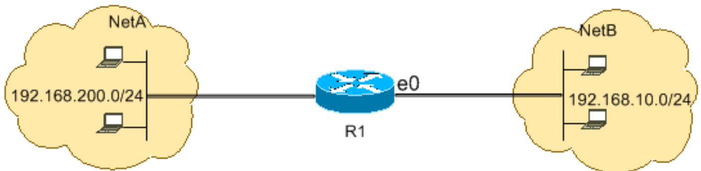
Cette configuration autorise l'accès à NetA des paquets IP portant une en-tête IP avec une adresse source comprise dans le réseau 192.168.10.0/24 et une adresse de destination comprise dans le réseau 192.168.200.0/24. Il y a une clause implicite de refus en fin d'ACL qui refuse l'accès à tout autre trafic via Ethernet 0 sur R1.
