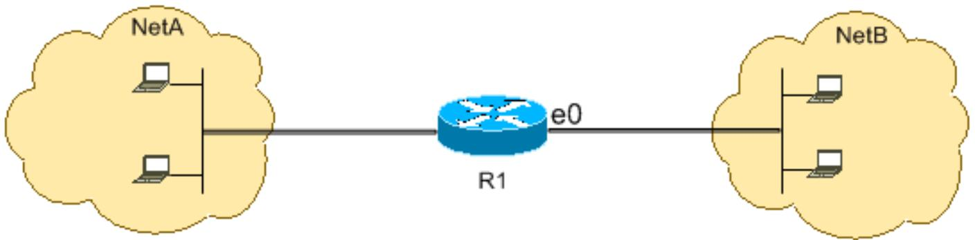
Cette configuration autorise uniquement les paquets à réponse d'écho (réponse ping) à entrer dans l'interface Ethernet 0 de NetB vers NetA. En revanche, elle bloque tous les paquets ICMP à requête d'écho lorsque les commandes ping sont originaires de NetB et destinées à NetA. Par conséquent, les hôtes de NetA peuvent utiliser les commandes Ping sur les hôtes de NetB, alors que les hôtes de NetB ne peuvent pas faire de même avec les hôtes de NetA.
