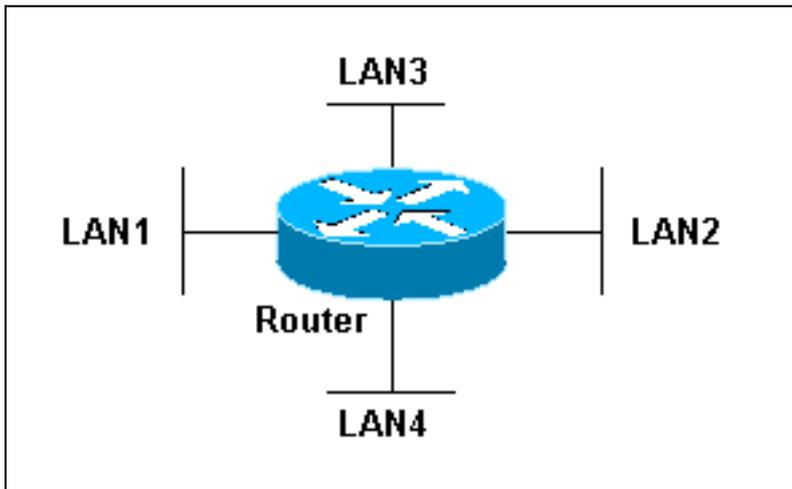
Dans cet exemple, le routeur agit comme deux ponts différents, l'un entre LAN1 et LAN2 et l'autre entre LAN3 et LAN4. Les trames du réseau local LAN1 sont pontées au réseau local LAN2, mais pas au réseau local LAN3 ou LAN4, et vice versa. En d'autres termes, les trames sont pontées uniquement entre les interfaces du même groupe. Cette fonction de regroupement est généralement utilisée pour séparer les réseaux ou les utilisateurs.
