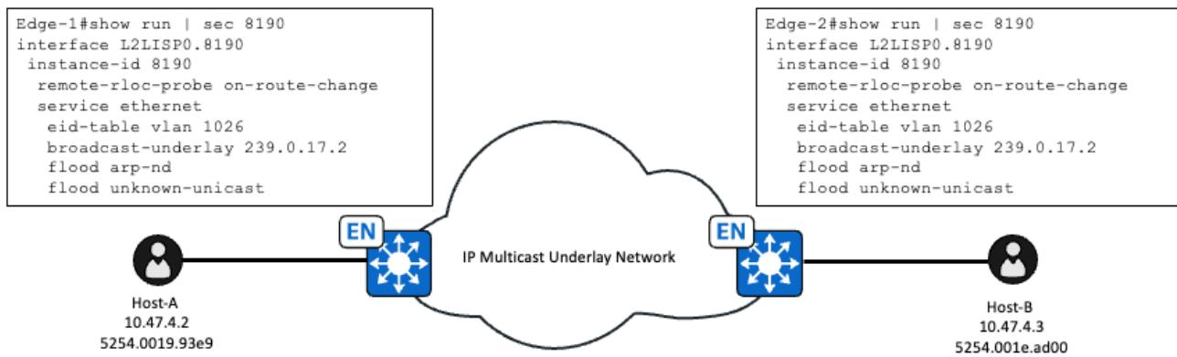
Une fois que la multidiffusion sous-jacente est configurée et que `flood arp-nd` est activé, cela change la façon dont la requête ARP est traitée, qui utilisait à l'origine la résolution basée sur LISP/SISF. Une fois que `flood arp-nd` est configuré sous l'instance LISP L2, ceci désactive la politique IPDT LISP-ARP-RELAY-VLAN pour le VLAN, et n'est pas utilisé.
